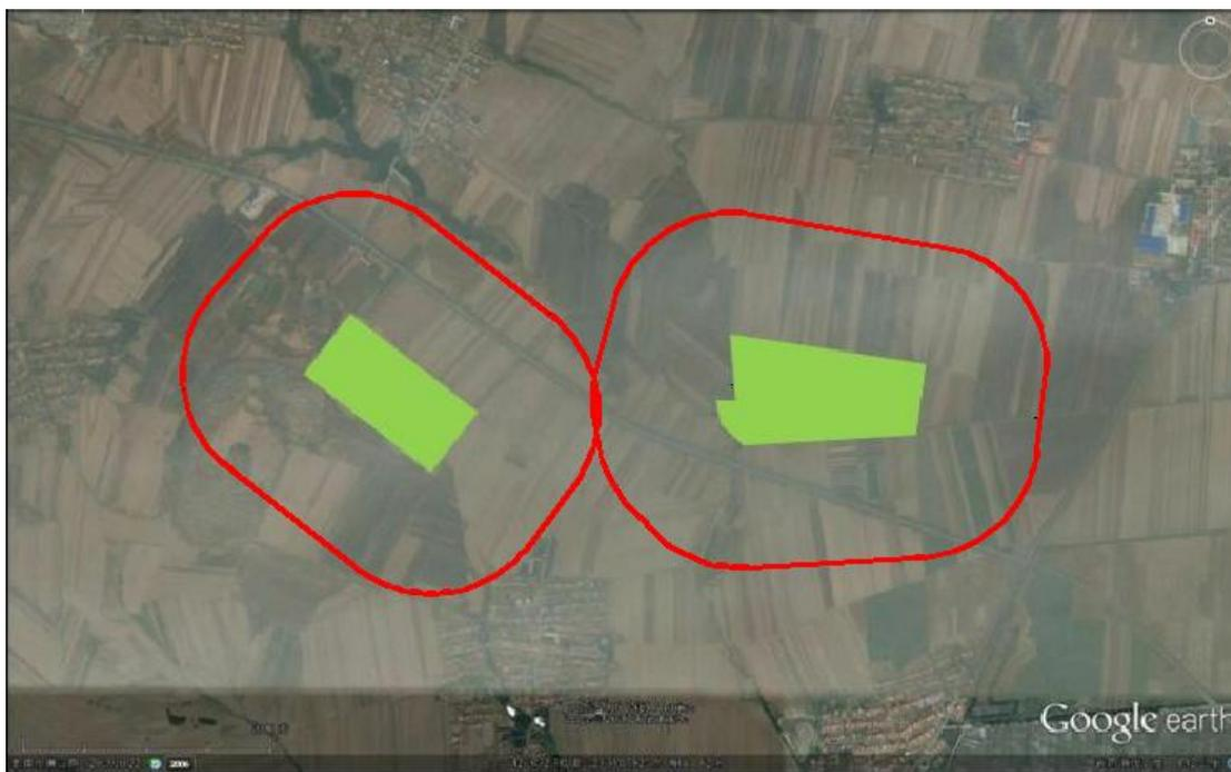
图 3-1 环评给出的卫生防护距离包络线图
