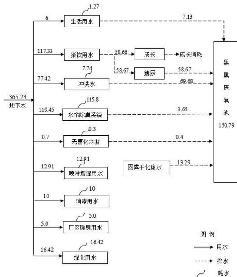
图 3-4 项目实际水量平衡图 单位: m<sup>3</sup>/d
