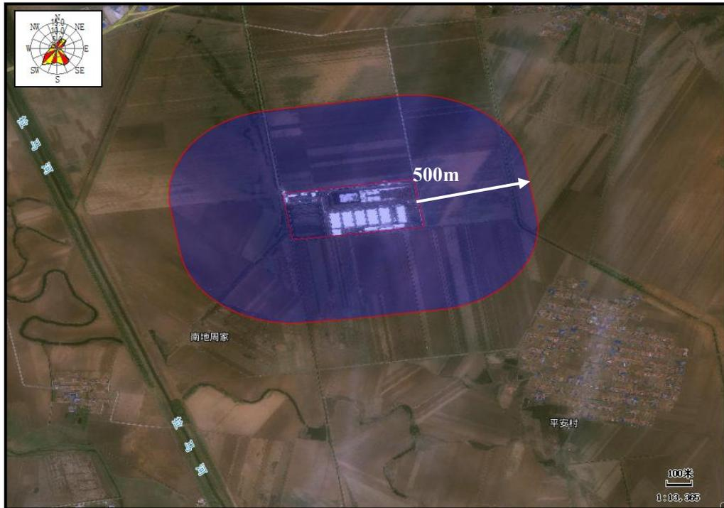
图 7-1 项目现状卫生防护距离包络线图
