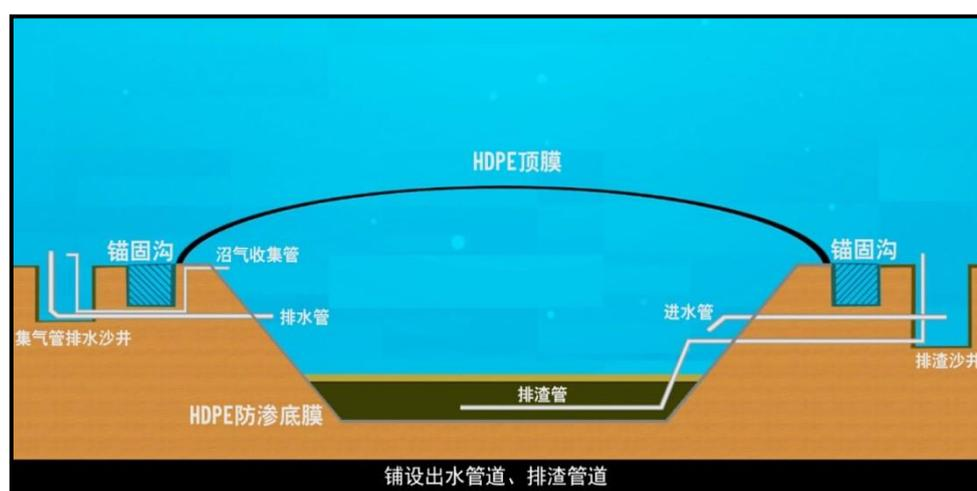
图 6-2 黑膜厌氧池结构示意图
