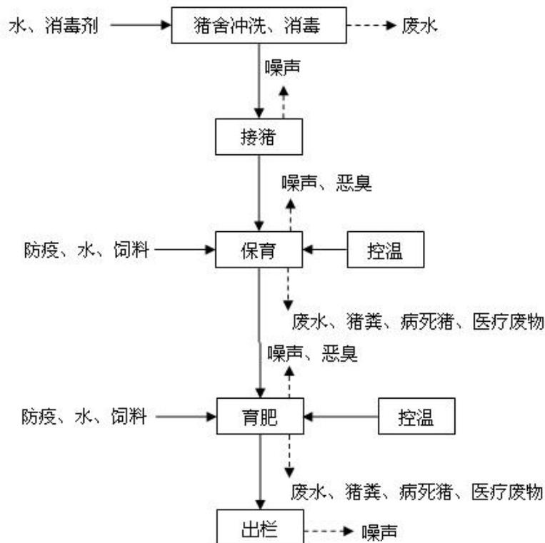
图 4-2 保育、育肥工艺流程及产污环节图
