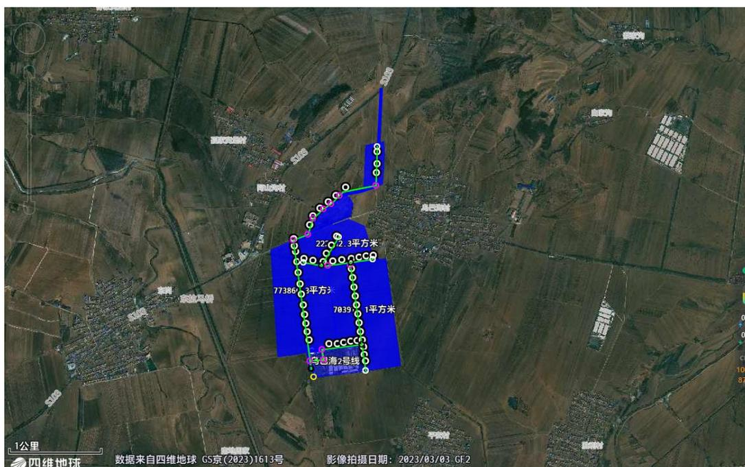
图 6-4 本项目的水肥施肥管网覆盖图
